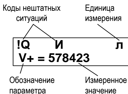
Рис.4. Размещение информации на индикаторе расходомера.
