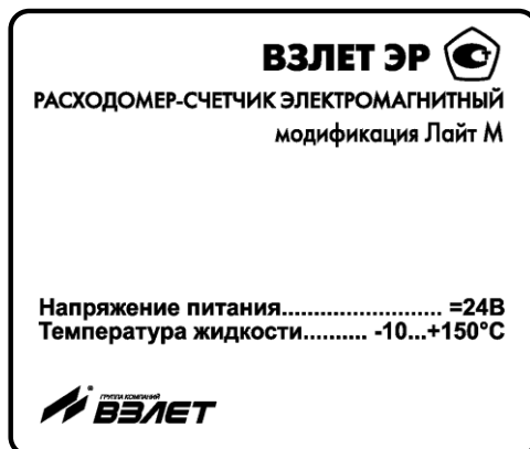
Рис.5. Вид маркировки на лицевой панели расходомера
