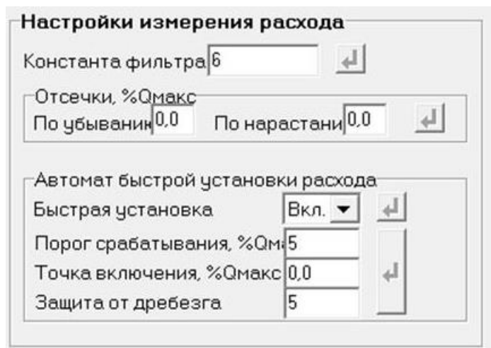
Рис.7. Вид области «Настройки измерения расхода».
